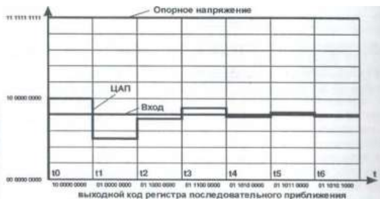
Рис. 2. Принцип работы АЦП последовательного приближения
