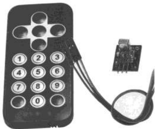
Рис. 8.3. IR-пульт (слева); плата IR-приемника (справа сверху); соединительные провода (справа внизу)
