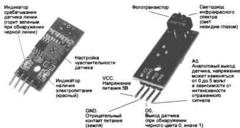
Рис. 9.5. Инфракрасный датчик отражения TCRT 5000: а — лицевая сторона; б — обратная
