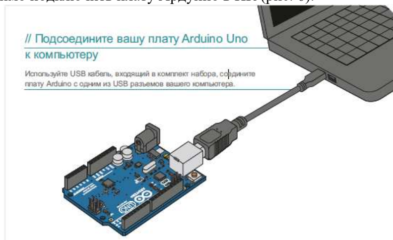
Рисунок 6 – Подключение Ардуино к ПК
