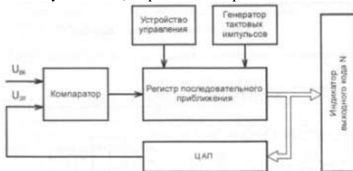
Рис. 30. Структурная схема одного канала АЦП последовательного приближения
