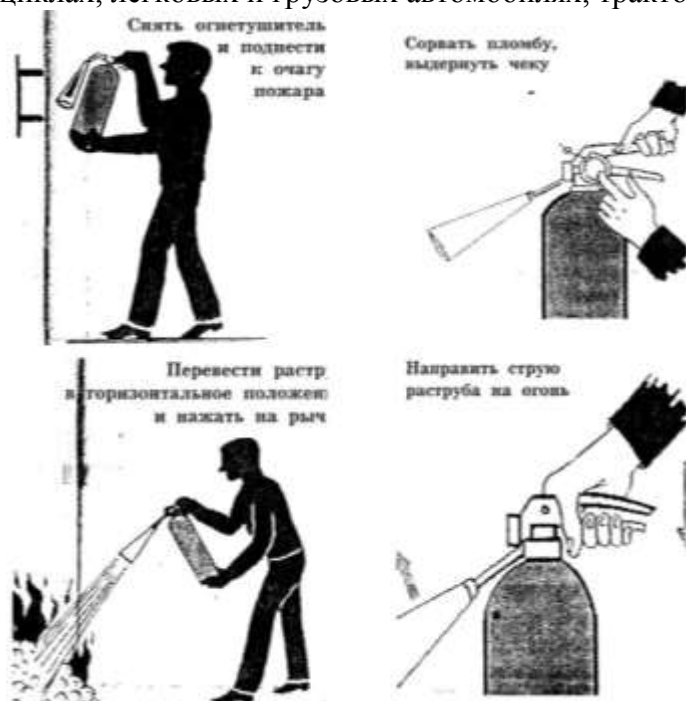
Рис. 3. Приведение в действие ручного углекислого огнетушителя.
