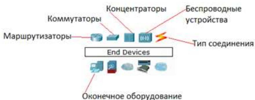
Рис. 5. Панель оборудования Packet Tracer
