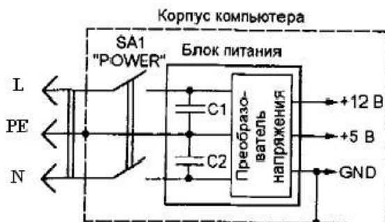
Рисунок 2 - Типовая схема подключения СВТ к питающей сети
