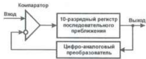
Рис. 1. Структура АЦП последовательного приближения
