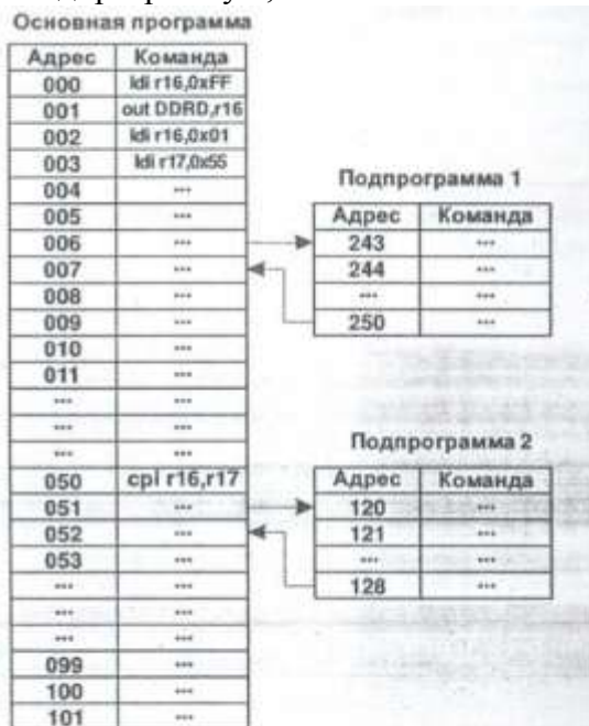
Рис. 1. Принцип работы указателя стека
