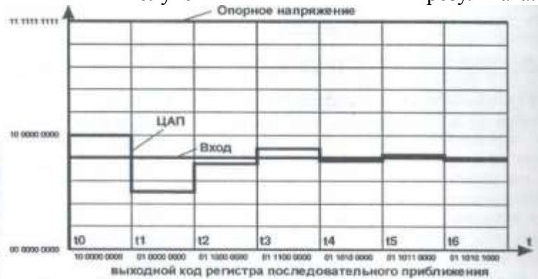
Рис. 2. Принцип работы АЦП последовательного приближения
