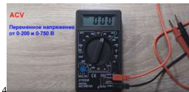
Рисунок 12 - Измерение переменного напряжения
