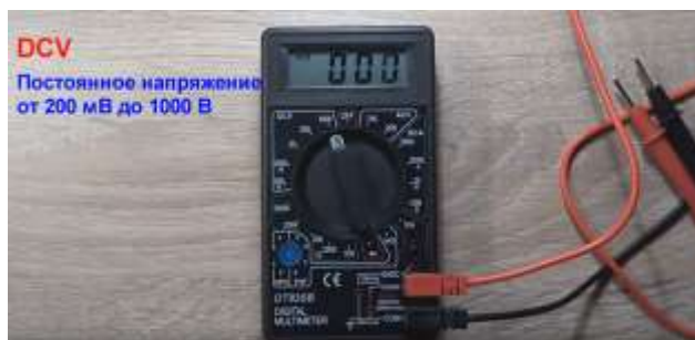
Рисунок 13 - Измерение постоянного напряжения
