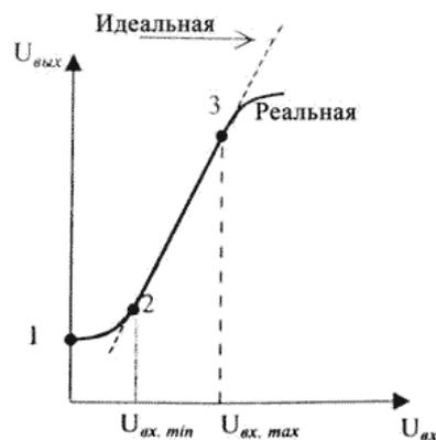
Рис.1 Амплитудная характеристика усилителя
