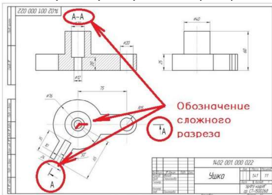
Рис 37 Обозначение сложного ломаного разреза на чертеже
