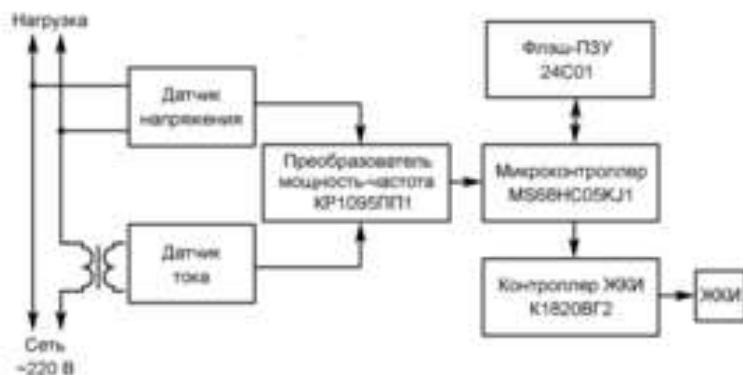
2. Изучите блок-схему многотарифного электронного счётчика электроэнергии и опишите функциональное назначение его узлов.
