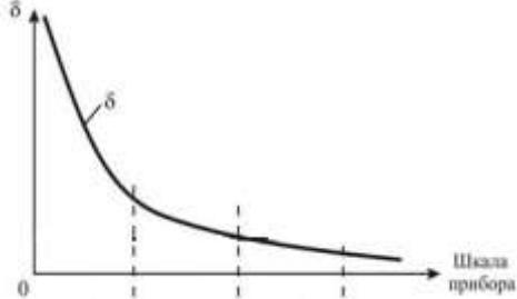
$= f(A_{изм})$  для вольтметра по данным табл.2. Сделать вывод о величине относительной погрешности измерения в начальной и конечной части шкалы, о характере изменения погрешности вдоль шкалы прибора.
