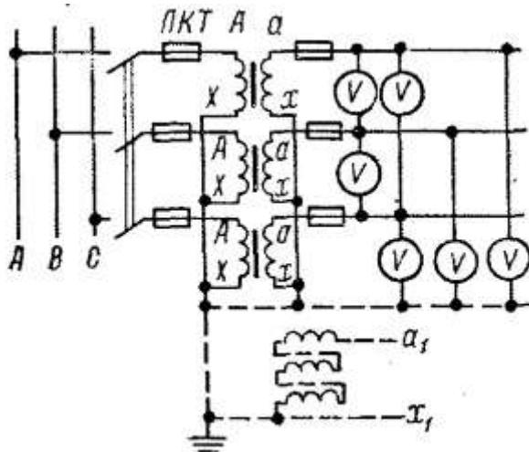
3. Перечертите в тетрадь схему. Напишите возле каждого вольтметра, какое напряжение он будет измерять.
