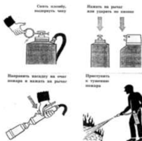
Рис.1. Приведение в действие воздушно-пенного огнетушителя.
