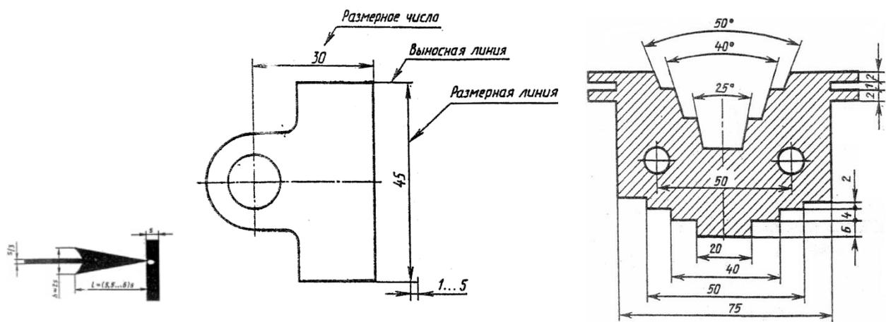
Рис.4 Нанесение размеров
