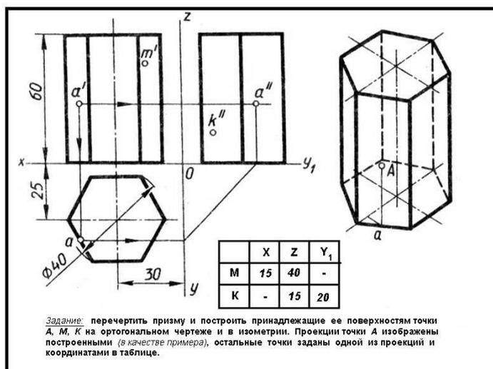
Рис.9 Проекции геометрических тел
