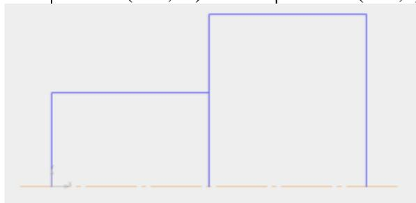
в) Перестроить фаску в угловых точках пересечения трех отрезков 1 и 2, 3 и 4, 4 и 5. Для этого на панели Геометрия выбрать инструмент Фаска
