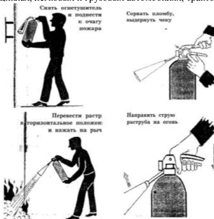
Рис. 3. Приведение в действие ручного углекислого огнетушителя.
