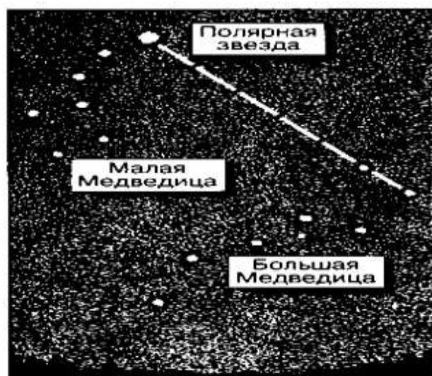
Рис. 3. Определение сторон горизонта по Полярной звезде
