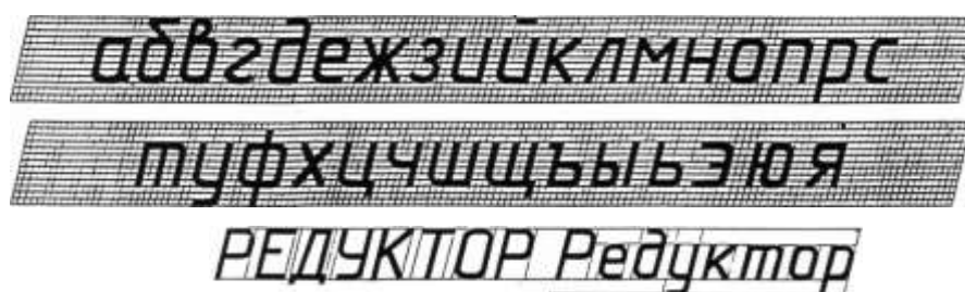
Рис.17 Буквы чертежного шрифта
