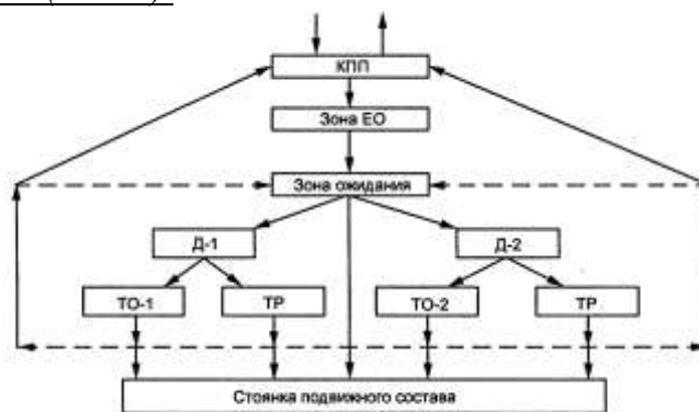
Рис. 4.1. Схема технологического процесса обслуживания автомобилей
