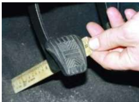
Рисунок 1- Проверка свободного хода педали сцепления
