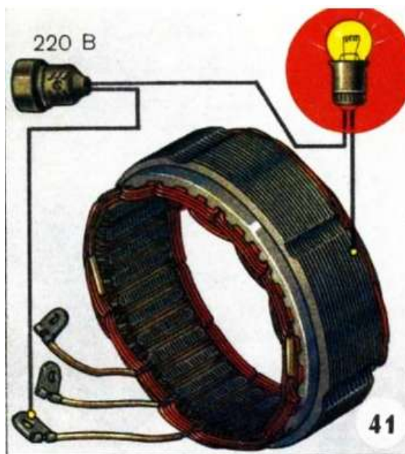
Рисунок 16 Проверка обмотки статора на замыкание с корпусом
