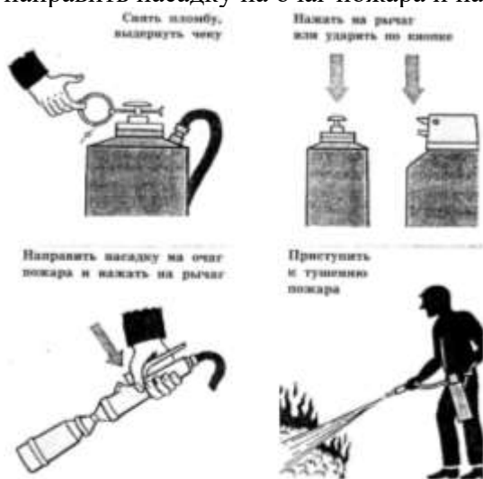
Рис.1. Приведение в действие воздушно-пенного огнетушителя.
