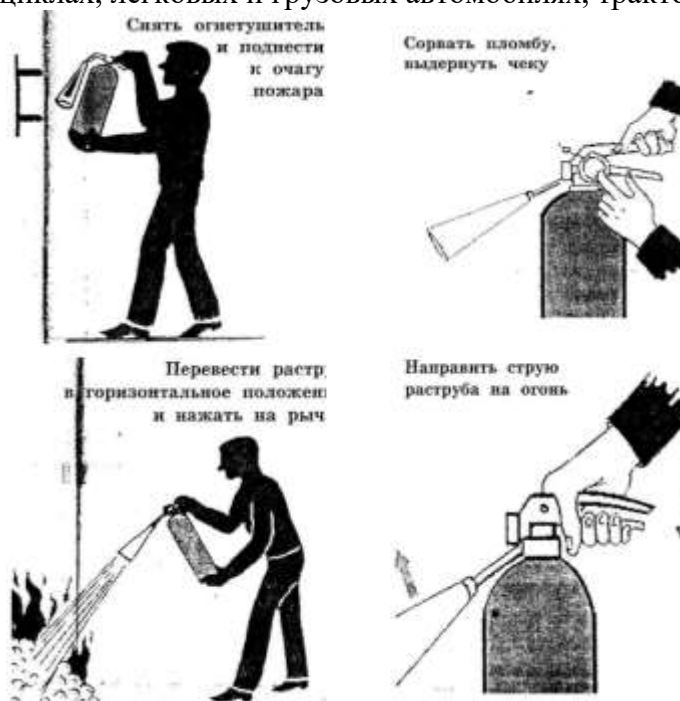
Рис. 3. Приведение в действие ручного углекислого огнетушителя.
