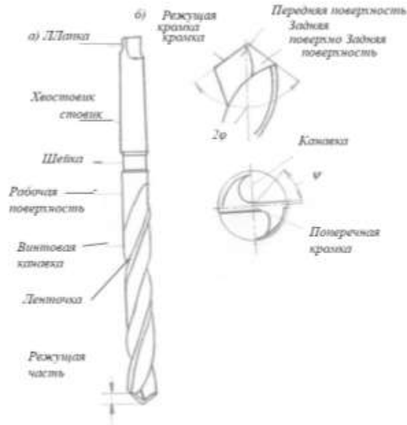
Рис.1. Части и элементы спирального сверла
