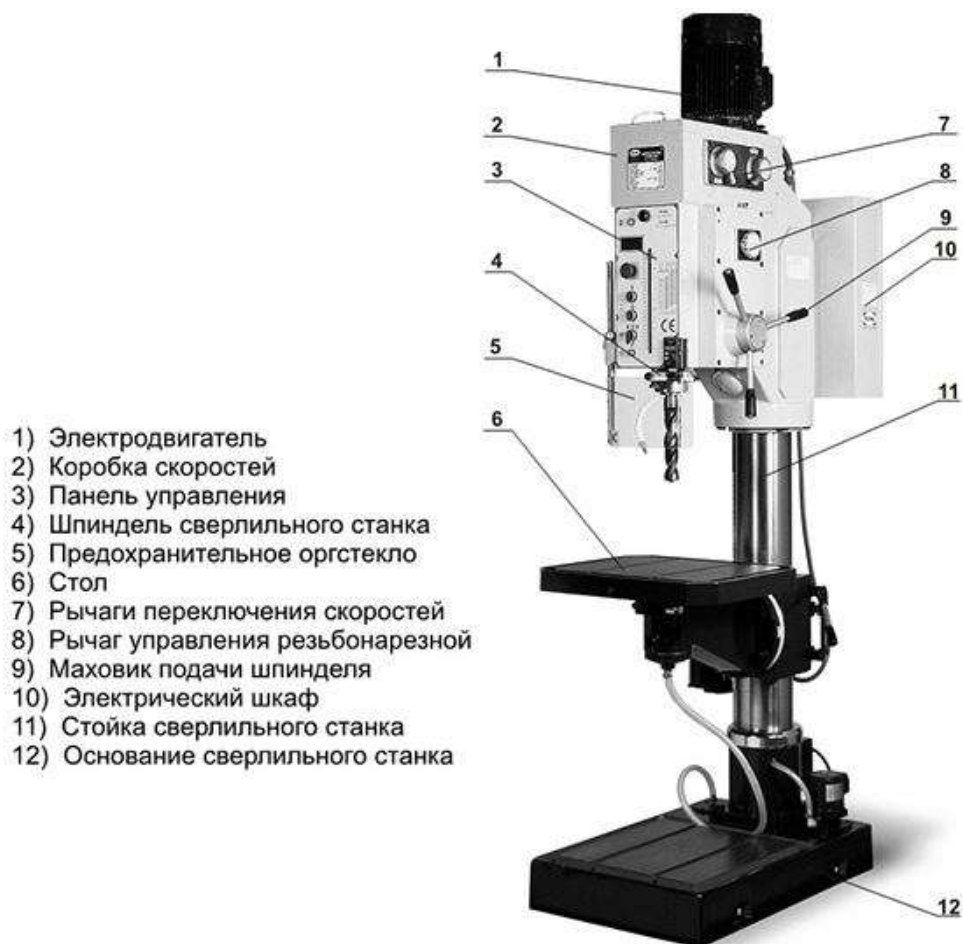
Основные узлы сверлильного станка
