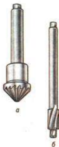
Рис. 1. Зенковки: a - коническая; б - цилиндрическая.
