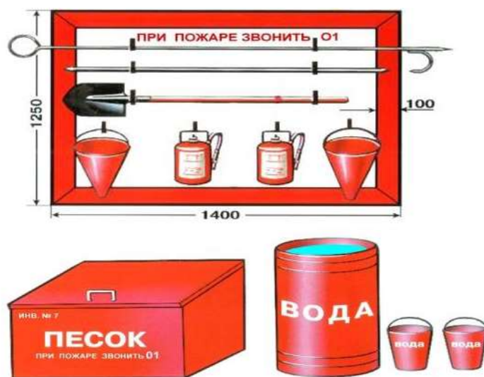
Рисунок 6 - Пожарный щит первичных средств пожаротушения
