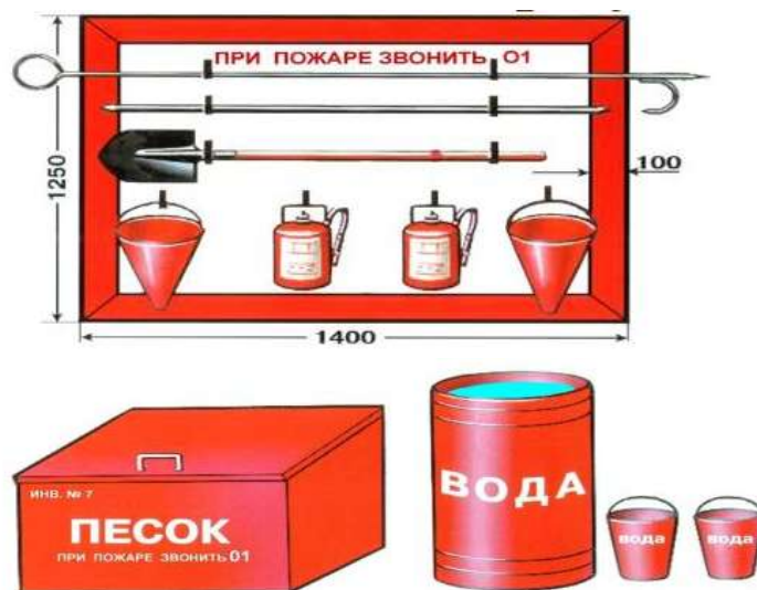
Рисунок 6 - Пожарный щит первичных средств пожаротушения
