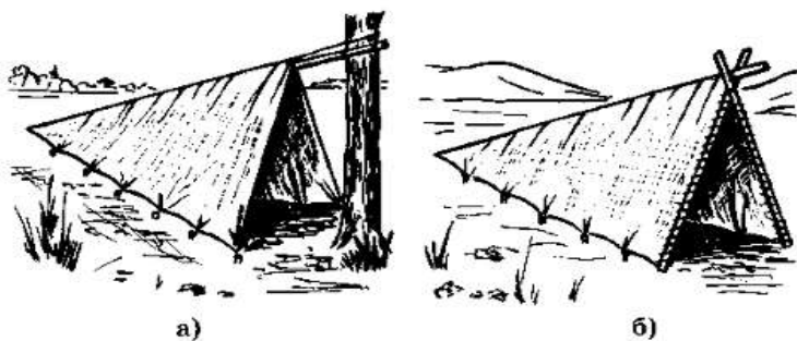
Рис. 7. Простейшие укрытия: а) шалаш из ткани, построенный с использованием дерева; б) шалаш, сооруженный из трех жердей
