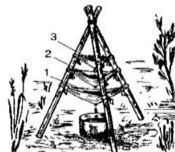
Рис. 15. Фильтрация воды: 1 — древесный уголь; 2 — песок; 3 — трава
