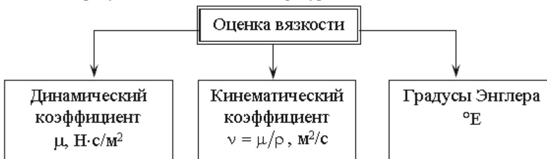
Рисунок 4 – Способы оценки вязкости жидкости
