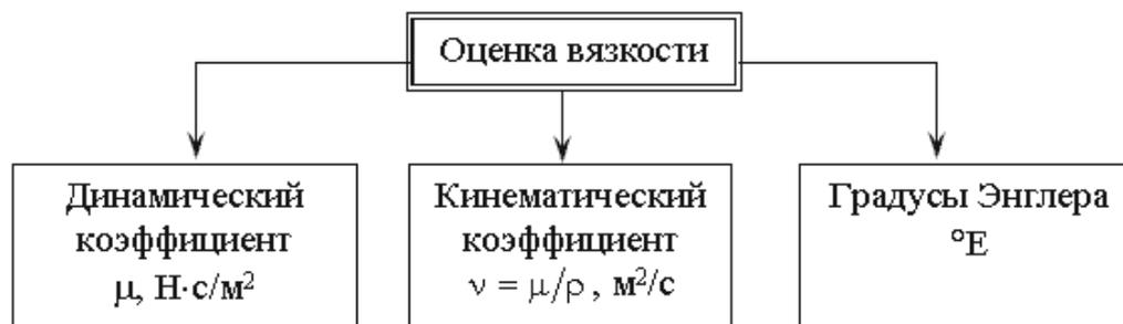
Рис. 1.8. Способы оценки вязкости жидкости
