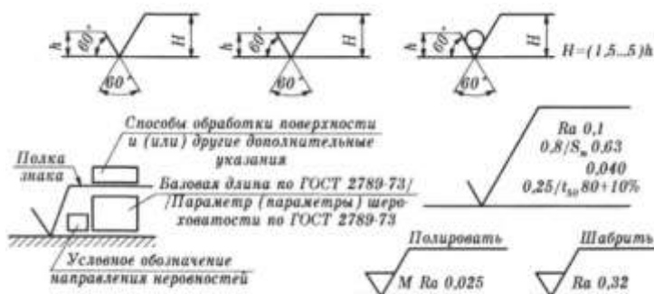
Рисунок 2 – Обозначения шероховатости поверхности
