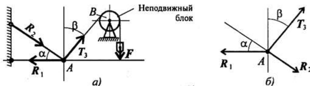
а) Силы, действующие на шарнир A .
