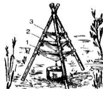
Рис. 15. Фильтрация воды: 1 — древесный уголь; 2 — песок; 3 — трава
