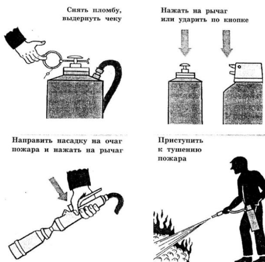
Рис.1. Приведение в действие воздушно-пенного огнетушителя.
