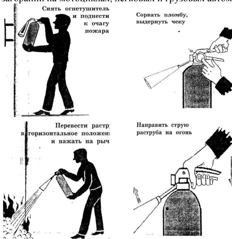
Рис. 3. Приведение в действие ручного углекислого огнетушителя.
