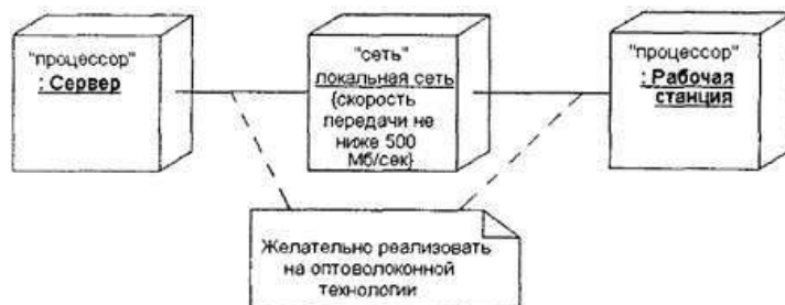
Рис. 3. Фрагмент диаграммы развертывания с соединениями между узлами
