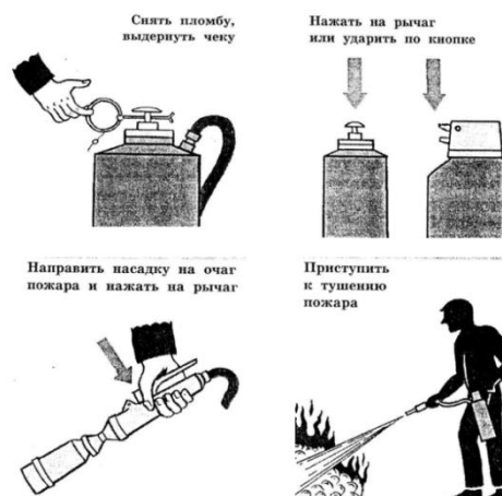
Рис.1. Приведение в действие воздушно-пенного огнетушителя.
