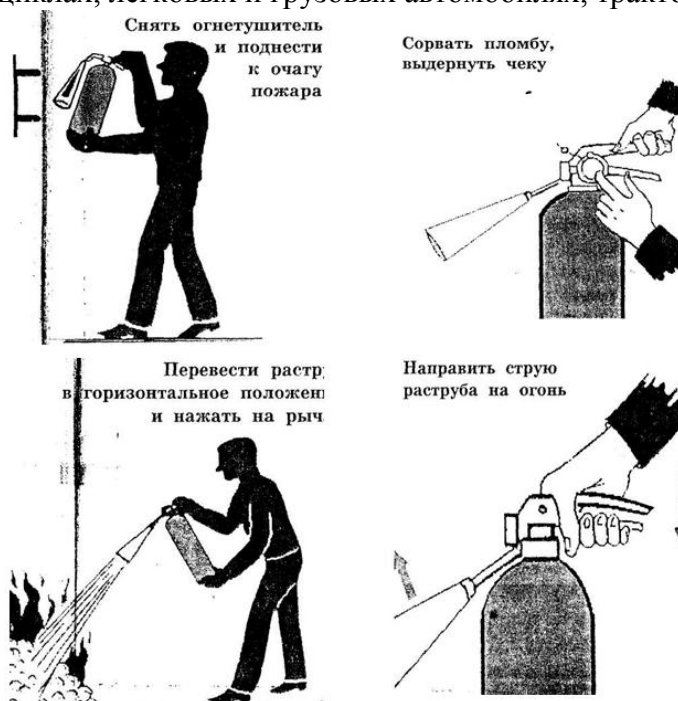
Рис. 3. Приведение в действие ручного углекислого огнетушителя.
