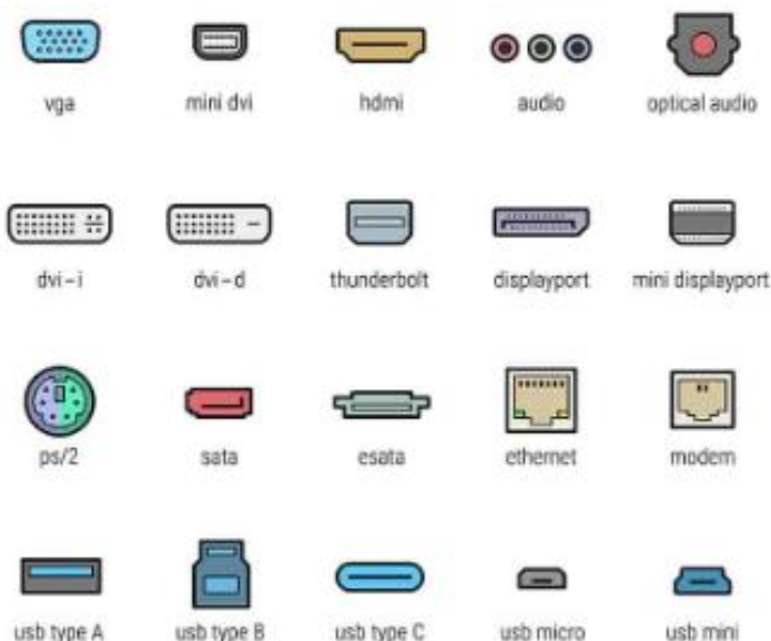
Рисунок 4 – Интерфейсы подключения периферийных устройств
