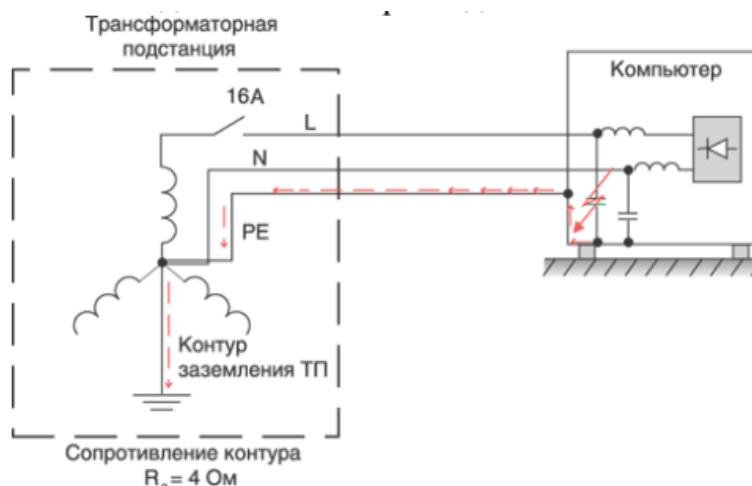
Рисунок 1 - Система заземления СВТ
