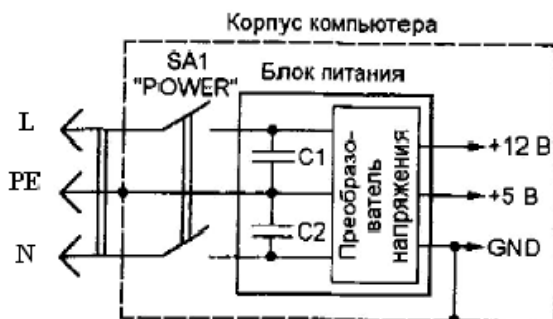
Рисунок 2 - Типовая схема подключения СВТ к питающей сети
