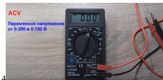
Рисунок 12 - Измерение переменного напряжения
