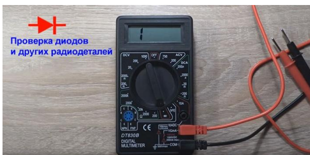
Рисунок 28 – Мультиметр для проверки диодов
