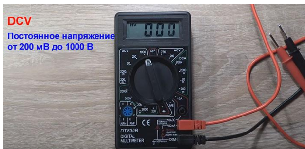
Рисунок 13 - Измерение постоянного напряжения
