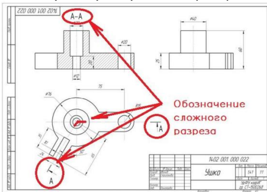
Рис 37 Обозначение сложного ломаного разреза на чертеже
