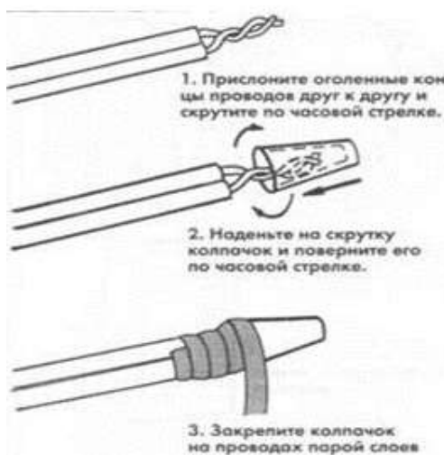
Рисунок 2 – Соединение жил кабеля
