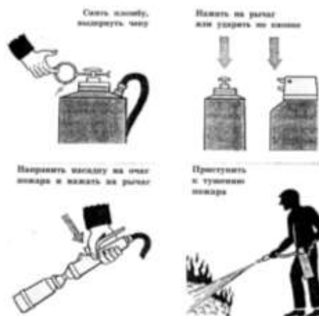
Рис.1. Приведение в действие воздушно-пенного огнетушителя.
