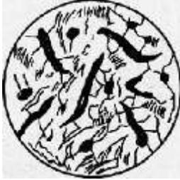
Рис. 8 Структура заэвтектического чугуна
