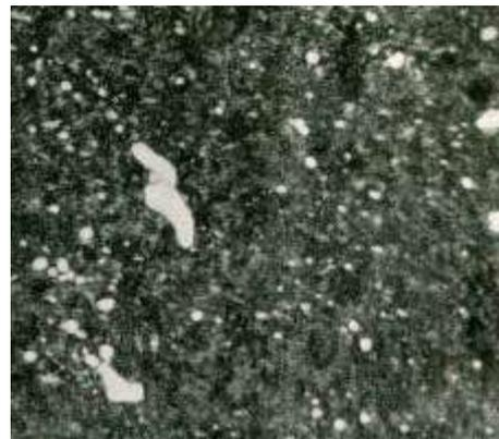
Рис.2 Микроструктура стали после закалки и многократного отпуска
