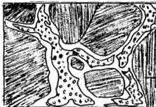
Рис. 5 Микроструктура оловянистой бронзы с 10 % Sn
