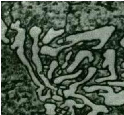
Рис.2 Микроструктура стали после отжига
