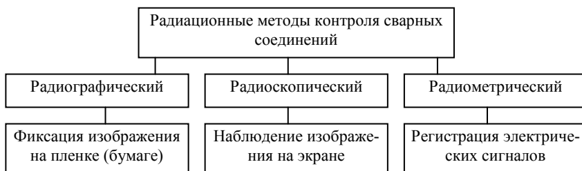
Схема 2,1. Способы детектирования радиографической информации
