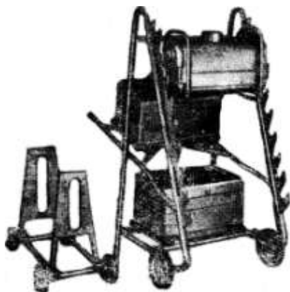
Рис. 2.3. Рентгеновский аппарат РУП-120-5-1
