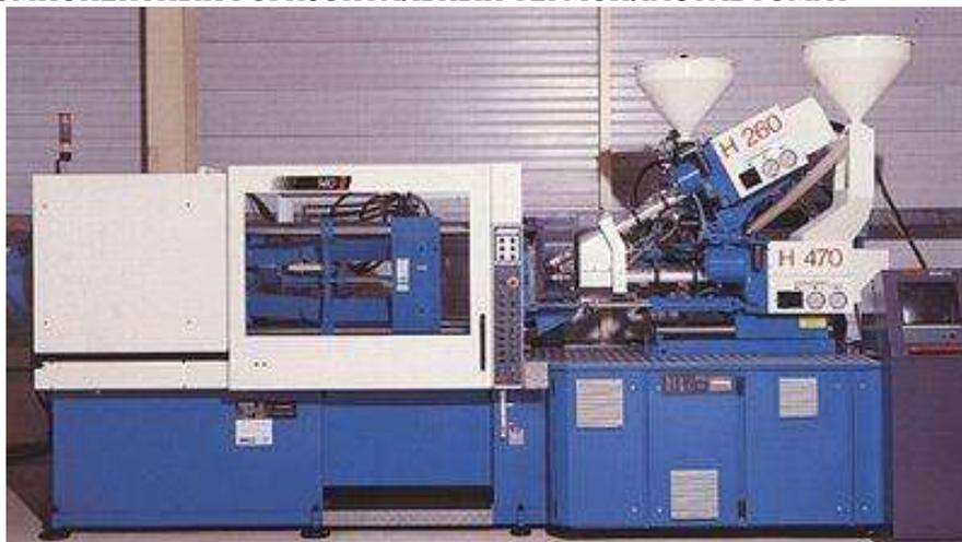
Рисунок 5.1 – Двухкомпонентный горизонтальный термопластавтомат
