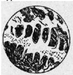
Рисунок 7 - Структура доэвтектического чугуна
