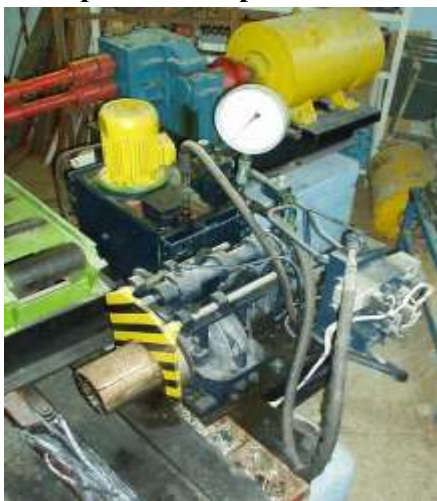
Рисунок 15 - Общий вид гидропривода моталки и сталкивателя рулонов
