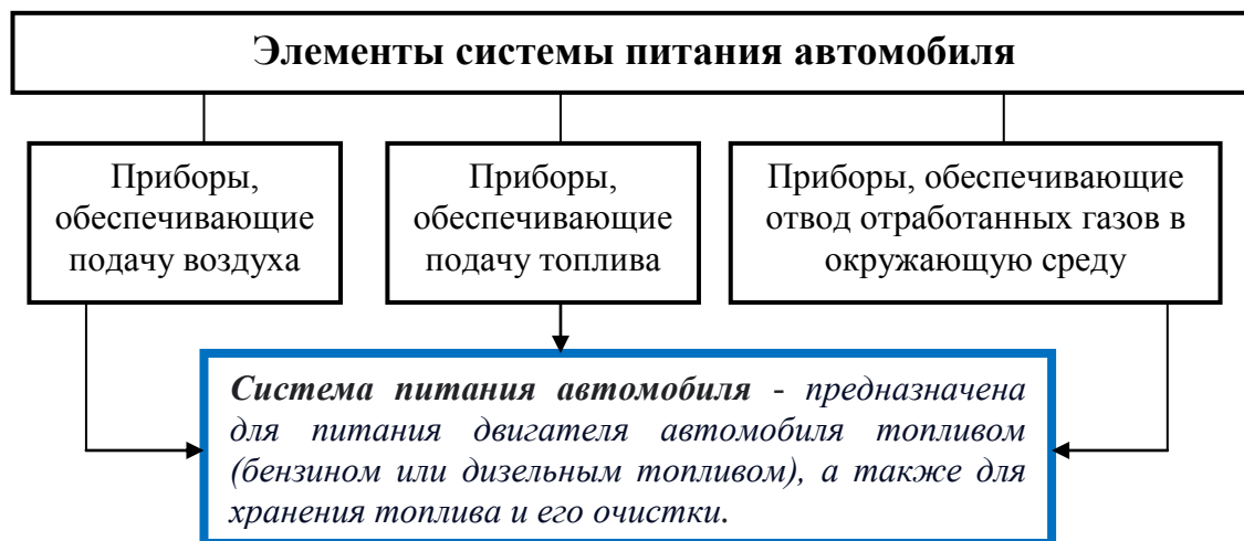
Рисунок 4 – Элементы системы питания автомобиля
