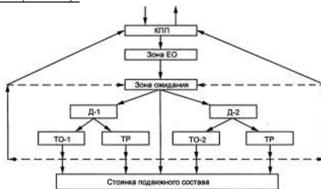
Рис. 4.1. Схема технологического процесса обслуживания автомобилей
