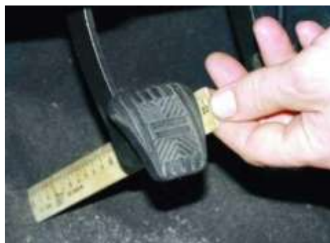
Рисунок 1- Проверка свободного хода педали сцепления
