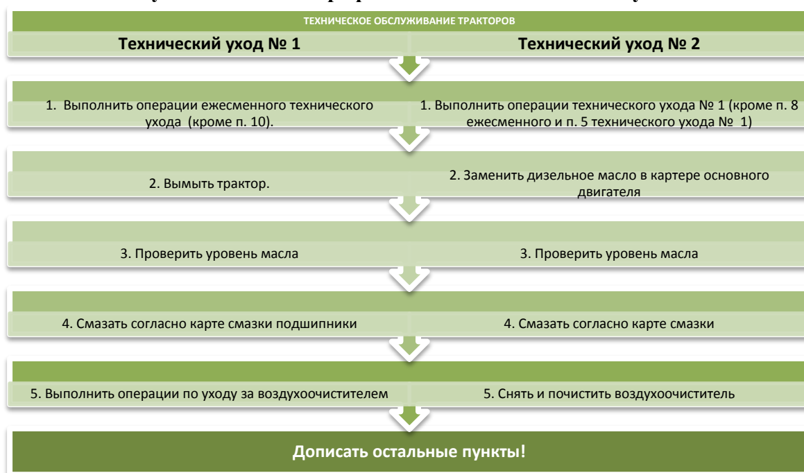
Рисунок 1 – Техническое обслуживание тракторов
