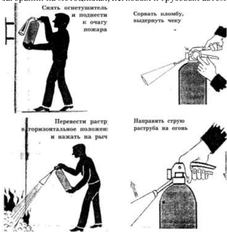
Рис. 3. Приведение в действие ручного углекислого огнетушителя.
