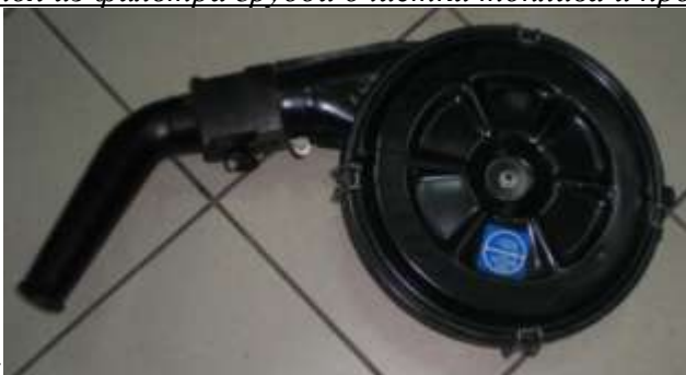
Рис. 1. Воздушный фильтр автомобиля
