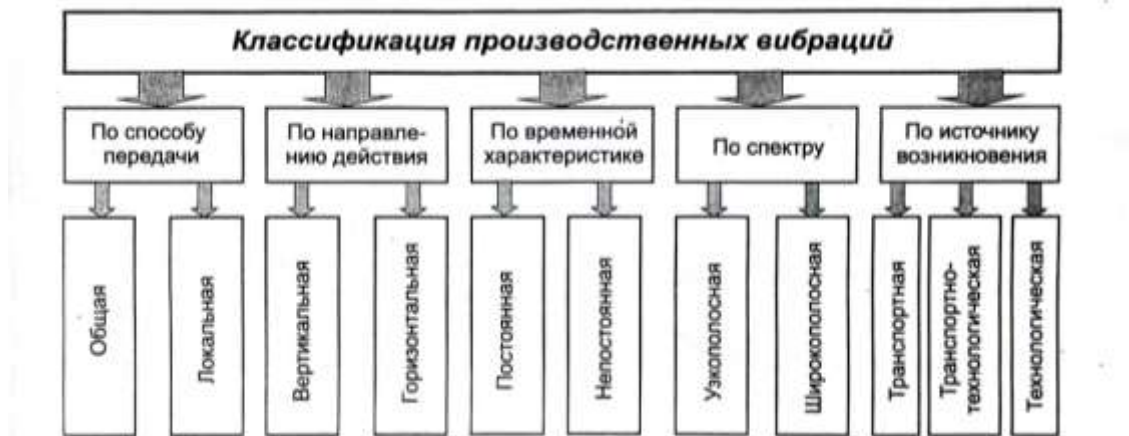
Рисунок 1 – Классификация производственных вибраций
