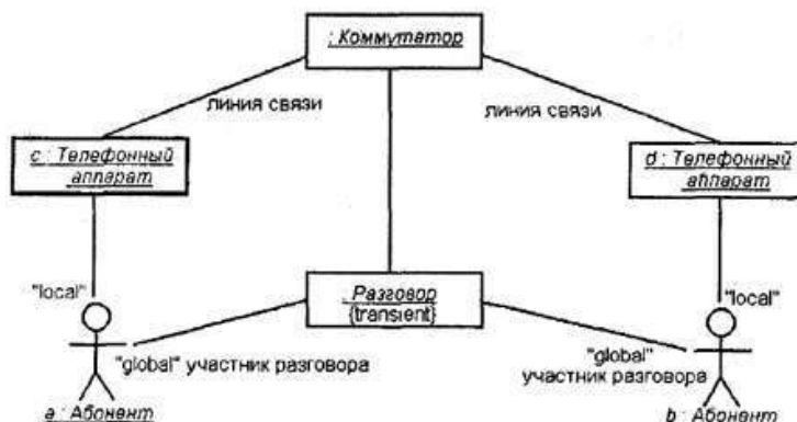
Рис. 9. фрагмент диаграммы кооперации, дополненный стереотипами ролей связей, именами ассоциаций и помеченным значением объекта.
